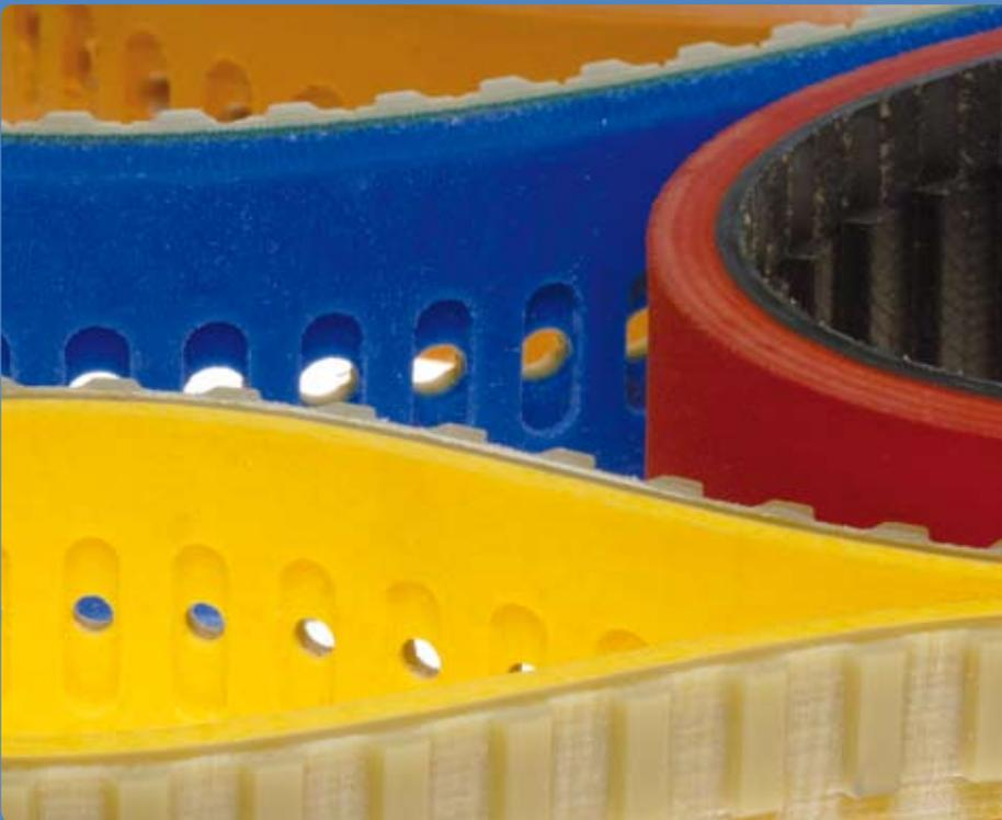
Die Bänder bestehen aus einem Zahn- oder Flachriemen aus PU/Kautschuk als Trägermaterial mit einer Polyurethan- oder Naturkautschukbeschichtung. Das Deckband kann endlos (ohne Naht- oder Klebestelle) oder mit Stoß ausgeführt werden. Alle Bänder werden auf genaue und gleichmäßige Dicke geschliffen.
